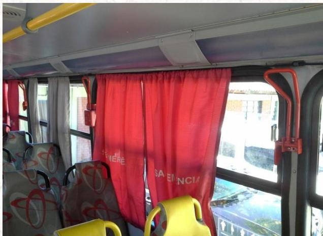
Suportes das alavancas de saída de emergência, quebrados ou arrancados, bancos pichados, lateral danificada,....
